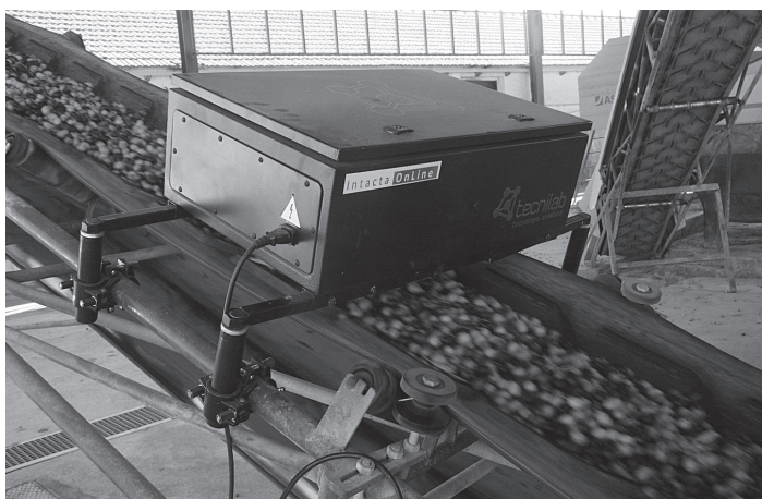
APLICACIÓN TECNOLOGÍA NIR EN ACEITUNA CARACTERIZACIÓN DEL FRUTO ENTERO EN TIEMPO REAL
