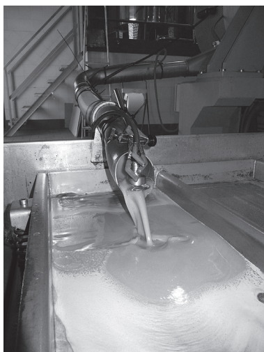
APLICACIÓN TECNOLOGÍA AOTF-NIR MULTIPLEXOR EN ALMAZARA 4. APLICACIÓN AOTF-NIR EN ACEITES A LA SALIDA DEL DECÁNTER
