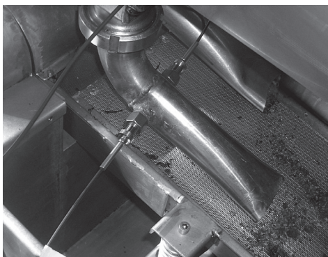
APLICACIÓN TECNOLOGÍA AOTF-NIR MULTIPLEXOR EN ALMAZARA 4. APLICACIÓN AOTF-NIR EN ACEITES A LA SALIDA DEL DECÁNTER
