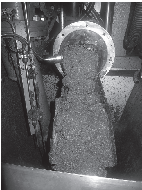
APLICACIÓN TECNOLOGÍA AOTF-NIR MULTIPLEXOR EN ALMAZARA 3. APLICACIÓN AOTF-NIR PARA CARACTERIZACIÓN DEL ORUJO A LA SALIDA DEL DECÁNTER
