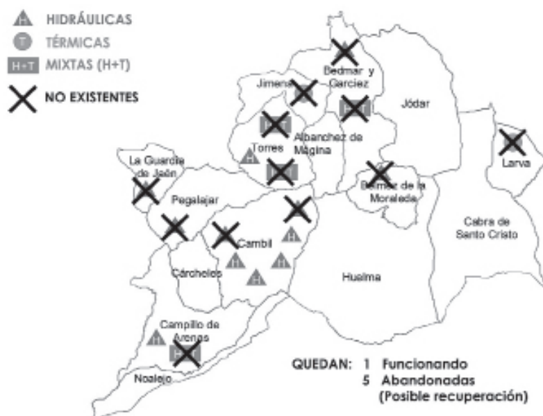
Figura 11: Situación actual de las minicentrales. 2014
